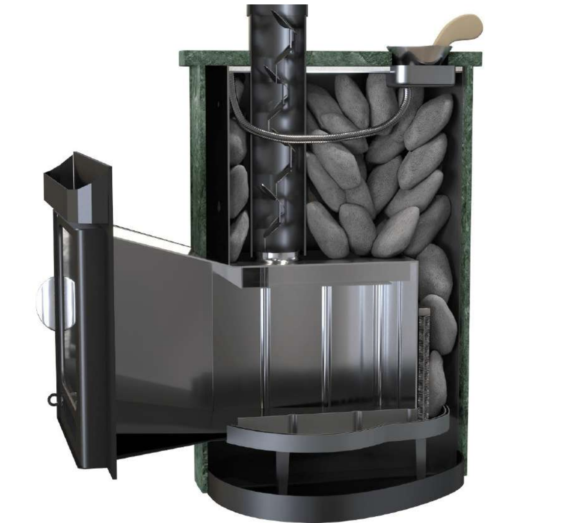
Рис.№ 14 Схема рекомендуемой закладки камня в каменку
